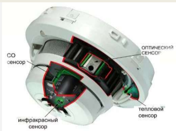
Устройство датчика дыма
